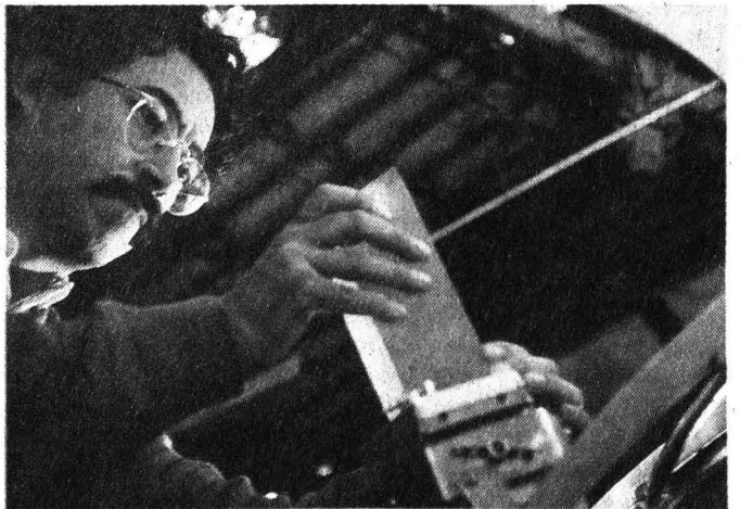
Salvador Cuevas probando una de las lentes de precisión astronómica que tiene el domo.
