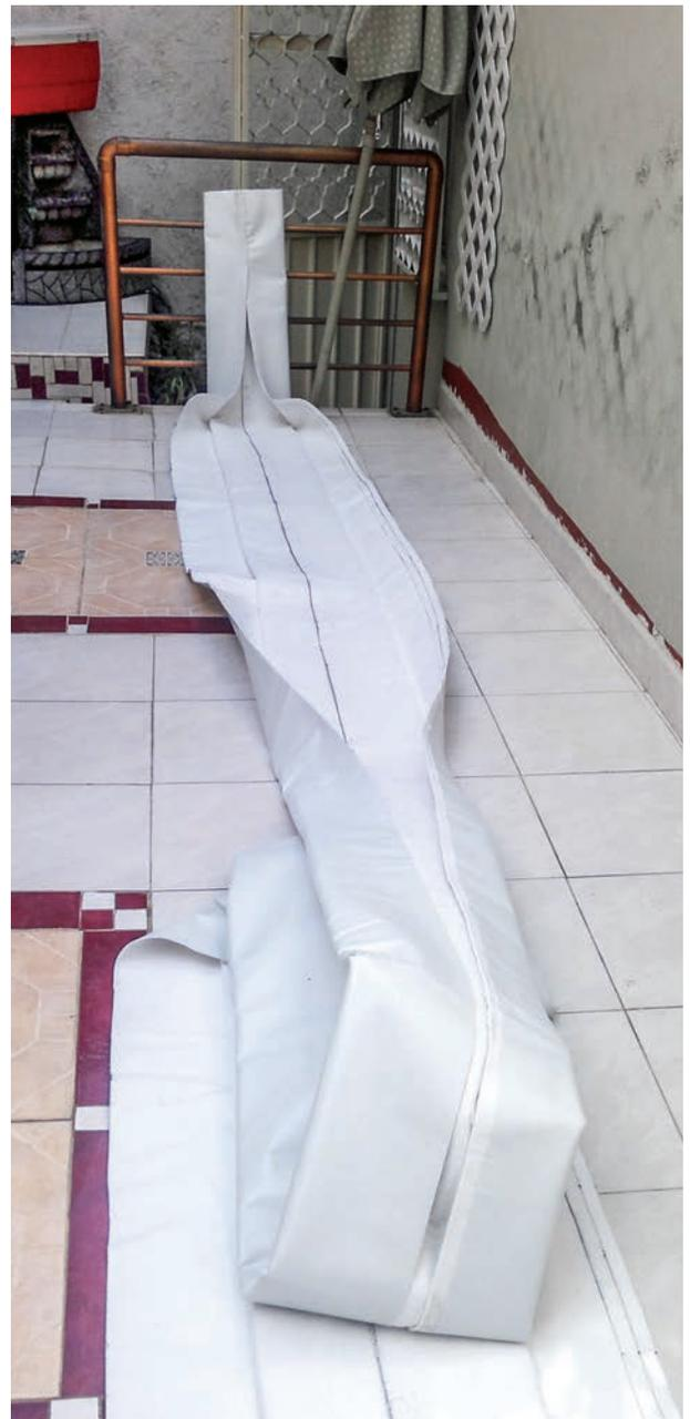
● Elaboran un liner con el diámetro, espesor y longitud precisas para la rehabilitación.
