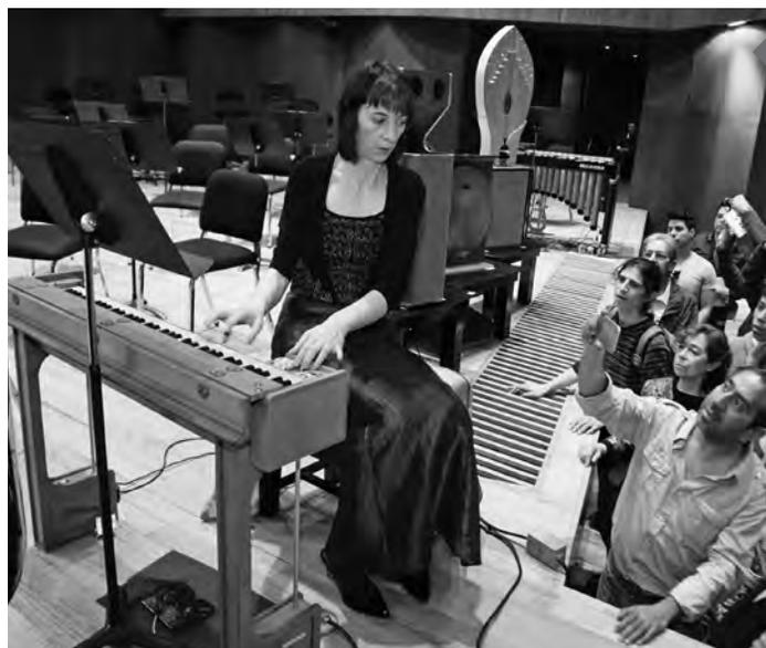
Ondas Martenot es un instrumento electrónico que no produce notas simultáneas. Está integrado por teclado, altavoz y generador de baja frecuencia. Fue inventado por el ingeniero y cellista francés Maurice Martenot en 1928.
