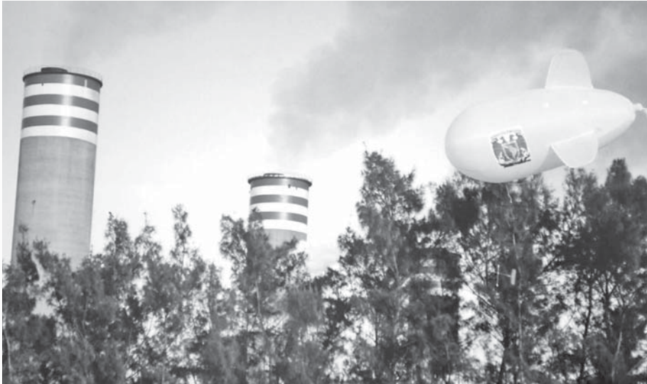
El globo tipo zepelín mide 4.5 metros de largo por 1.5 de ancho y lleva un paquete de sensores. Foto: cortesía del Laboratorio de Instrumentación Atmosférica.
