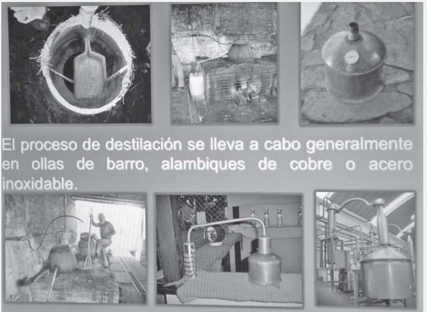
El proceso de destilación se lleva a cabo generalmente en ollas de barro, alambiques de cobre o acero inoxidable.
