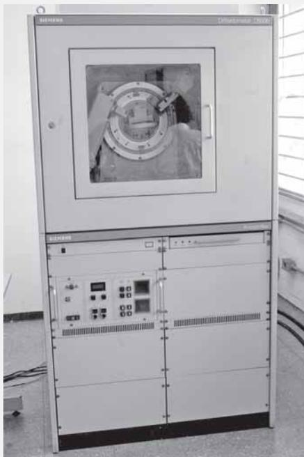
Un difractor de rayos X, parte del equipo utilizado en la investigación.
