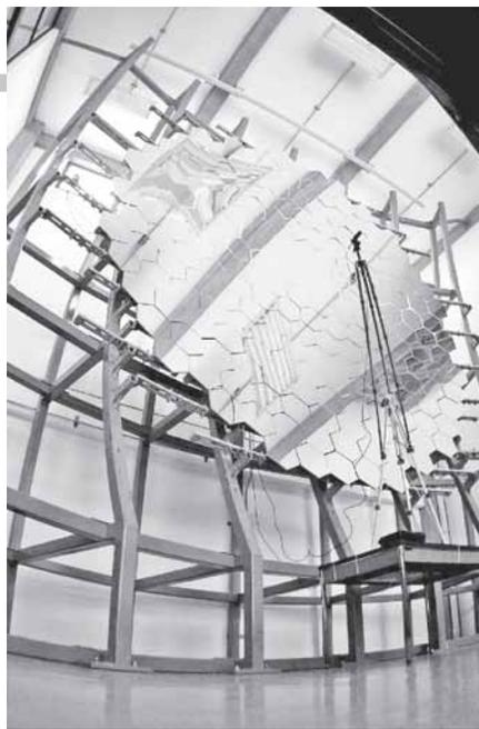
Espejos del horno solar de alto flujo radiativo.
