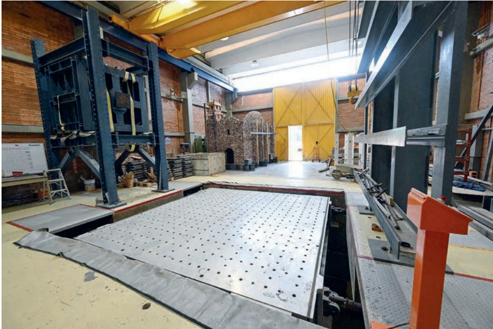
● La mesa vibradora, simulador de sismos, verifica la seguridad de las construcciones.
