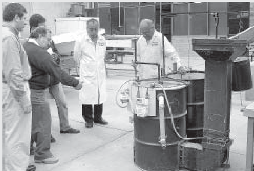
El biodigestor sirve para obtener gas natural a partir de la biomasa que defecan los animales. Fotos: Justo Suárez.
