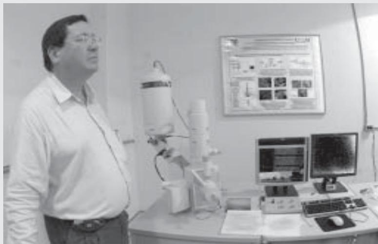
Microscopio electrónico de barrido, que se utiliza en las pruebas de la TV en tercera dimensión.
